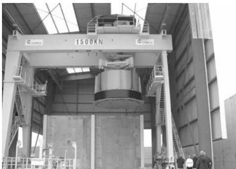
Figure 5. Stockage en ouvrage dédié d'un couvercle de cuve de réacteur à eau sous pression (90 à 120 tonnes).
